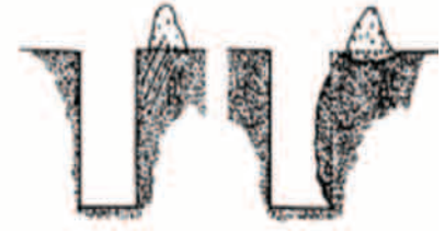
Şekil 9: Ağır yükler, dar kesitli kazının duvarlarına basınç uygularlar 2 .
