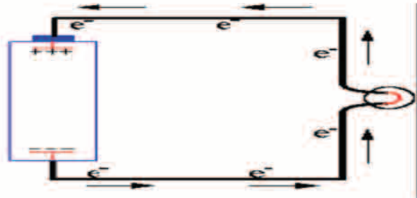
» Şekil 3: Elektrik akımı ve yönü
